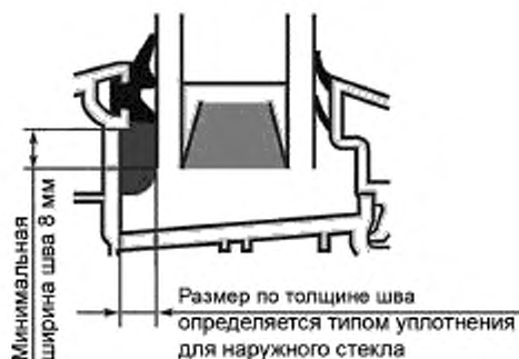
Рисунок 2 — Пример конструкции узла вклейки стеклопакета
