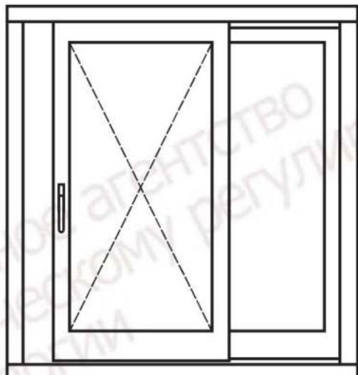
Рисунок Б.5.2 — Схема сдвижного открывания
